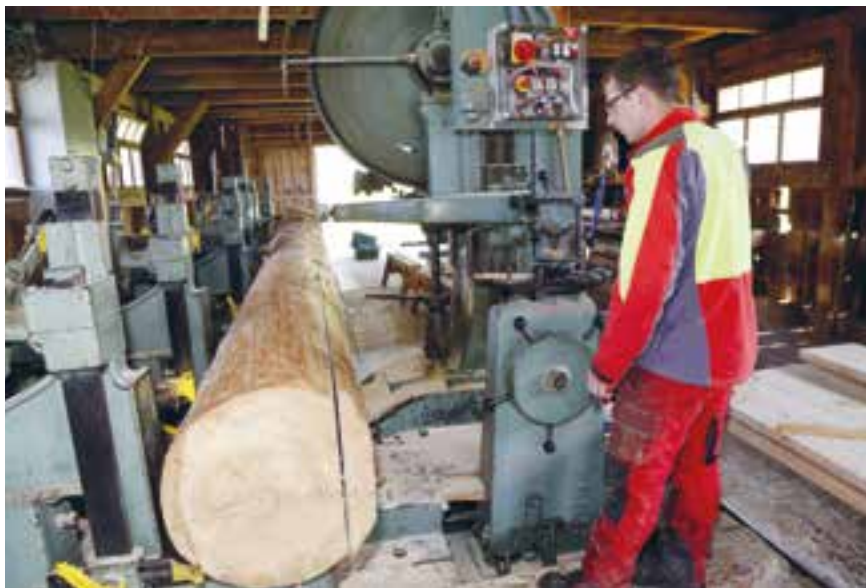
Die Bedienung der alten Blockbandsäge verlangt von Forstwart Ueli Bühler grosse Aufmerksamkeit und viel technisches Geschick.
