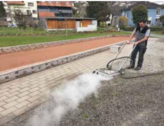
Das Heissdampfsystem zur Unkrautbekämpfung kann entweder von Hand bedient (hier durch Werkhofmeister Patrick Marxer) oder am Kommunalfahrzeug montiert werden.
