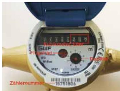
Ab 2014 eingesetzter Wasserzähler der WLU mit Literauflösung.
