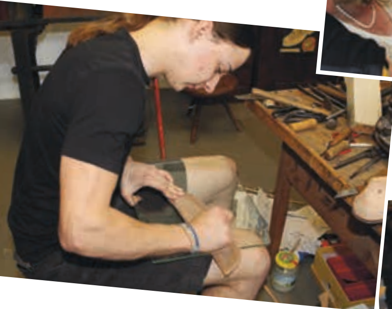
Die Hinterkappe wird ausgeschärft (am Rand ausgedünnt).
