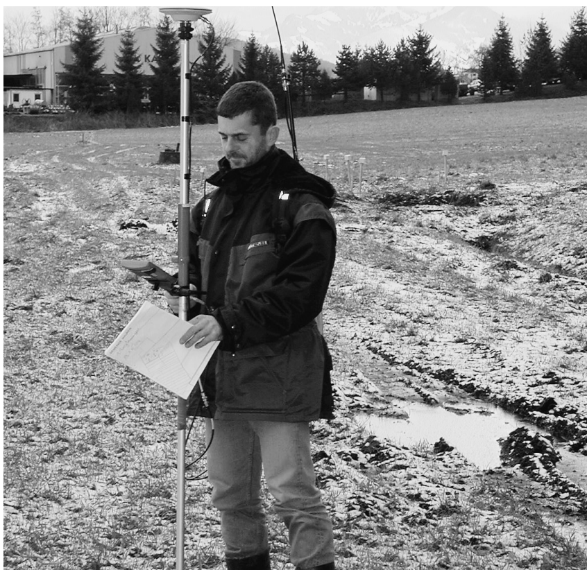
Thomas Fluck, Vermessungstechniker, bei der Absteckung eines fehlenden Grenzpunktes im Maurer Riet anhand eines GPS-Gerätes, das eine genaue Standortberechnung ermöglicht.
