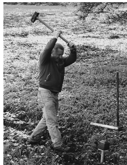
Bruno Büchel, Vermessungsassistent, beim Versetzen einer Kunststoffmarke.
